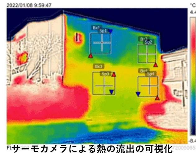
サーモカメラによる熱の流出の可視化
