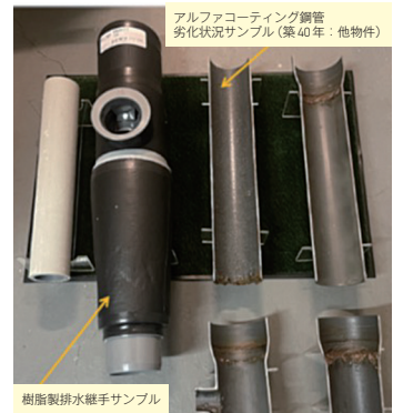
樹脂製排水継手と既存鋼管
